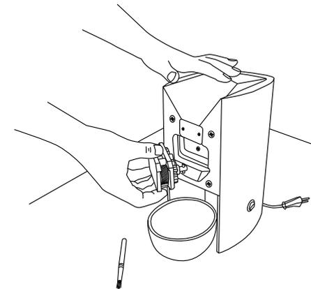
Die Abdeckplatte ist mittels Magneten befestigt und kann leicht mit der Hand entfernt werden.
