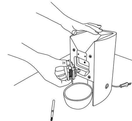
La placa de cubierta se fija con imanes y puede retirarse fácilmente con la mano.
