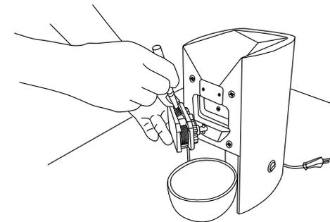
Nach der Reinigung das Gerät in umgekehrter Reihenfolge wieder zusammensetzen.
