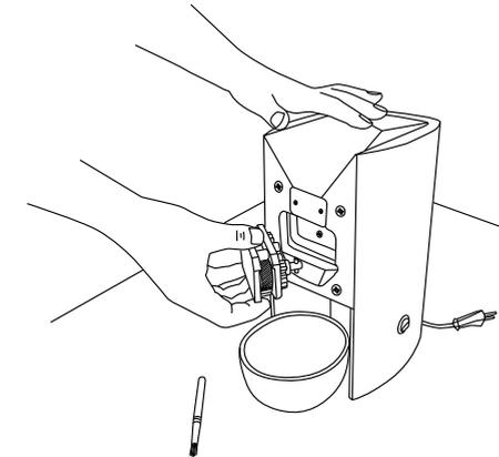
La piastra di copertura è fissata tramite magneti e può essere facilmente rimossa a mano.
